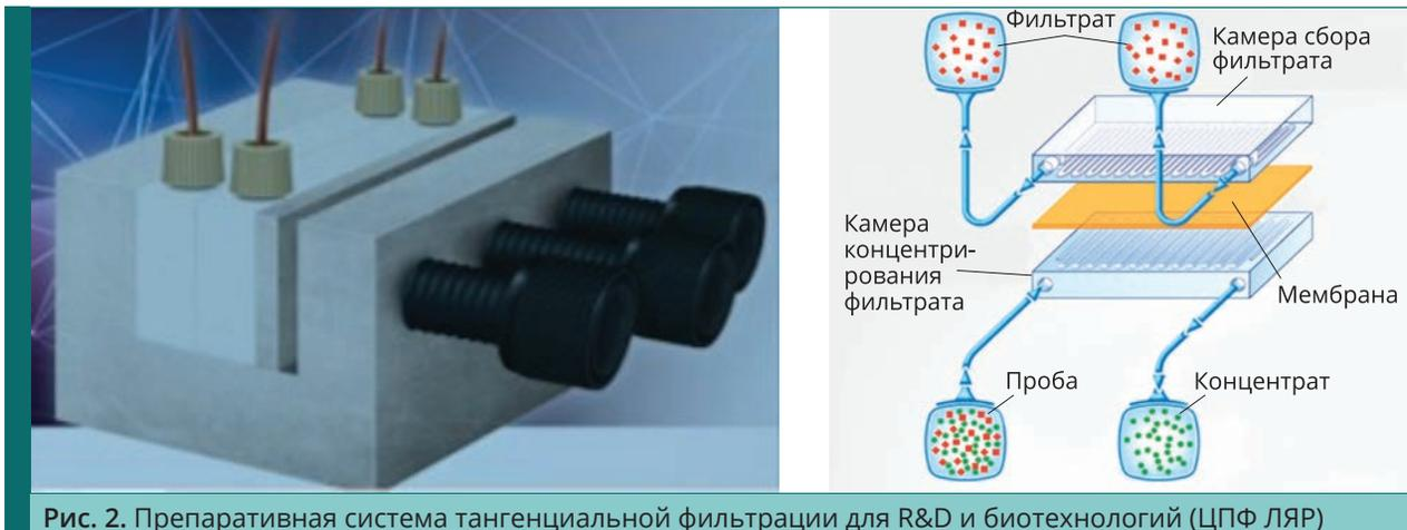
Рис. 2. Препаративная система тангенциальной фильтрации для R&D и биотехнологий (ЦПФ ЛЯР)
